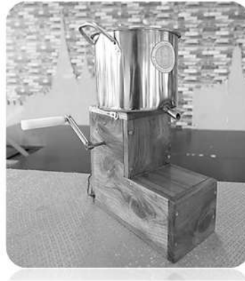
ภาพที่ 1 การออกแบบและการพัฒนาเครื่องสลัดน้ำมันสำหรับอาหารทอด
